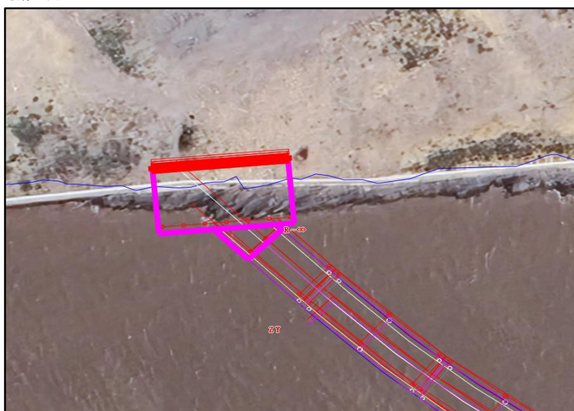
图 3.2-0 (1) 起点钢平台优化后与修测岸线叠图
